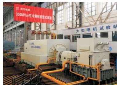
图15 300 MVar 空冷同步调相机厂内型式试验
