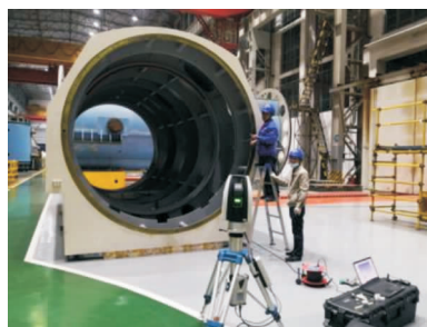
图8 发电机机座空间尺寸三维检测
