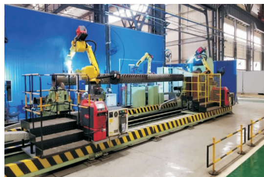
图2 集箱短管座机器人焊接产线全貌
