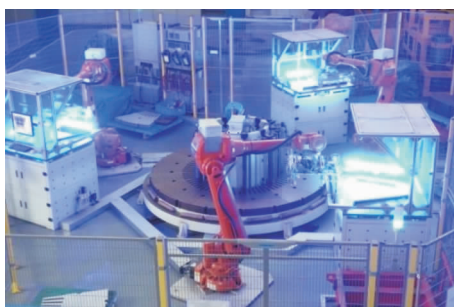
图7 定子铁心机器人自动叠片
