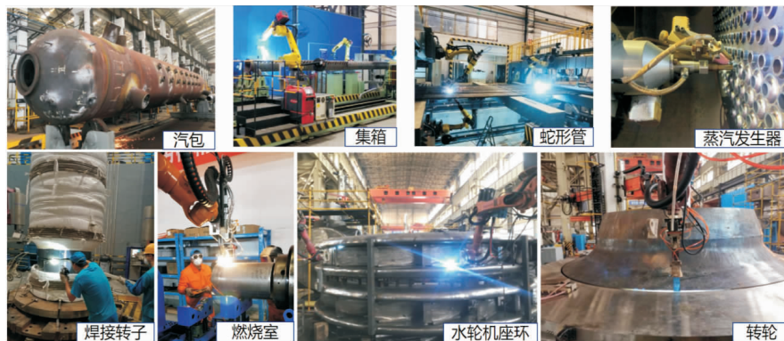
图1 焊接在发电装备产品中的应用实例
