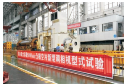
图16 50 MVar 凸极空冷调相机厂内型式试验
