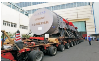
图11 全球首台 ERP1 750 MW 发电机定子发运
