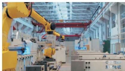
图 21 转子线圈自动线铣孔
