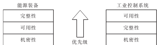
图3 能源装备与工业控制系统的信息安全三要素优先级对比
