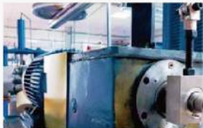
회전 시험 장치 PV 평가, 힘 5kN
