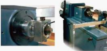
회전 시험 장치 PV 평가, 힘 35kN
