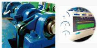
진동 운동에 대한 시험 장치 힘 615kN
